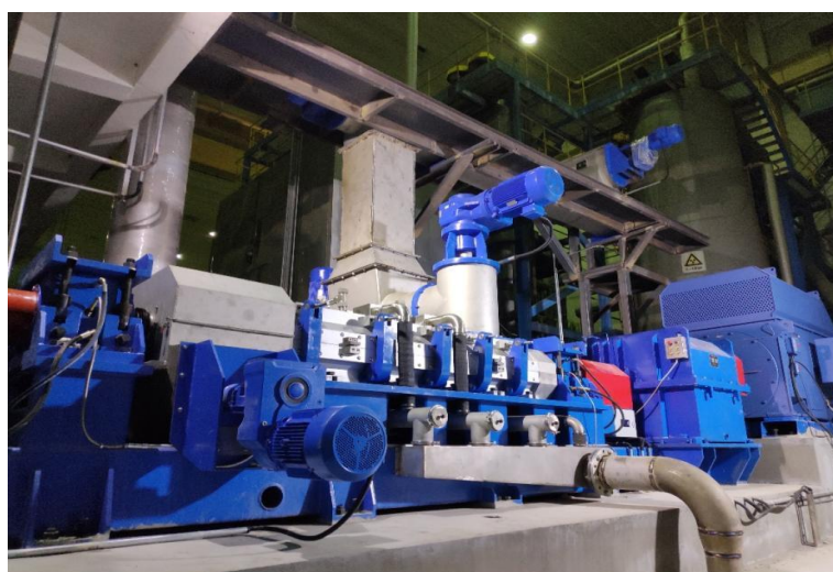
多级差速揉搓挤压浸渍系统
