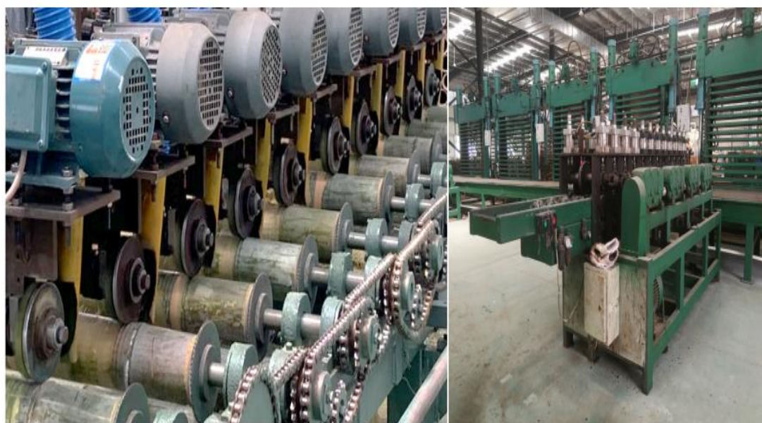
无裂纹展平竹材生产过程
