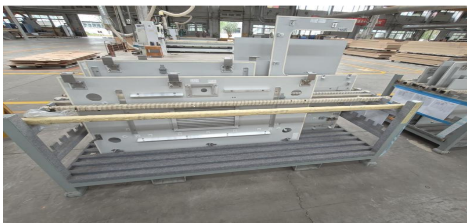
智能动车组列车顶板(阻燃型热塑性树脂胶合板)
