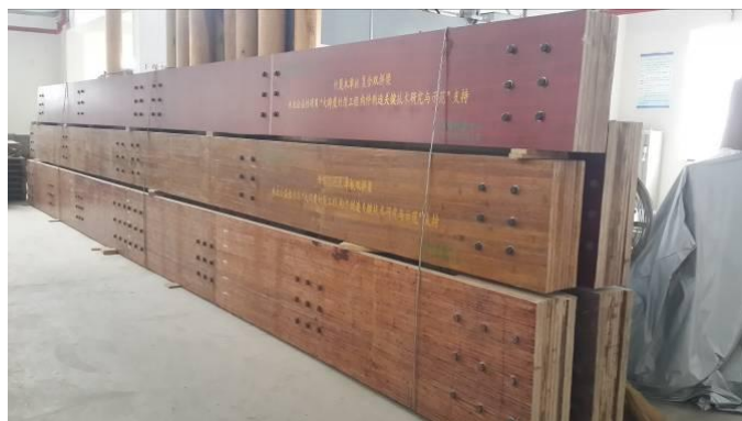
超长竹束单板层积材（14.1 米）三种竹质拼梁实物图（12m）
