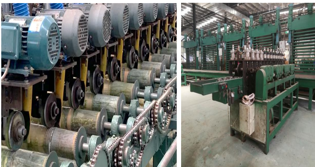
无裂纹展平竹材生产过程
